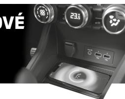
Příhrádka pro bezdrátové nabíjení je ukázkovým příkladem pohodlí a praktičnosti. Nabíjení spustíte jednoduše tím, že chytrý telefon položíte do příhrádky.
